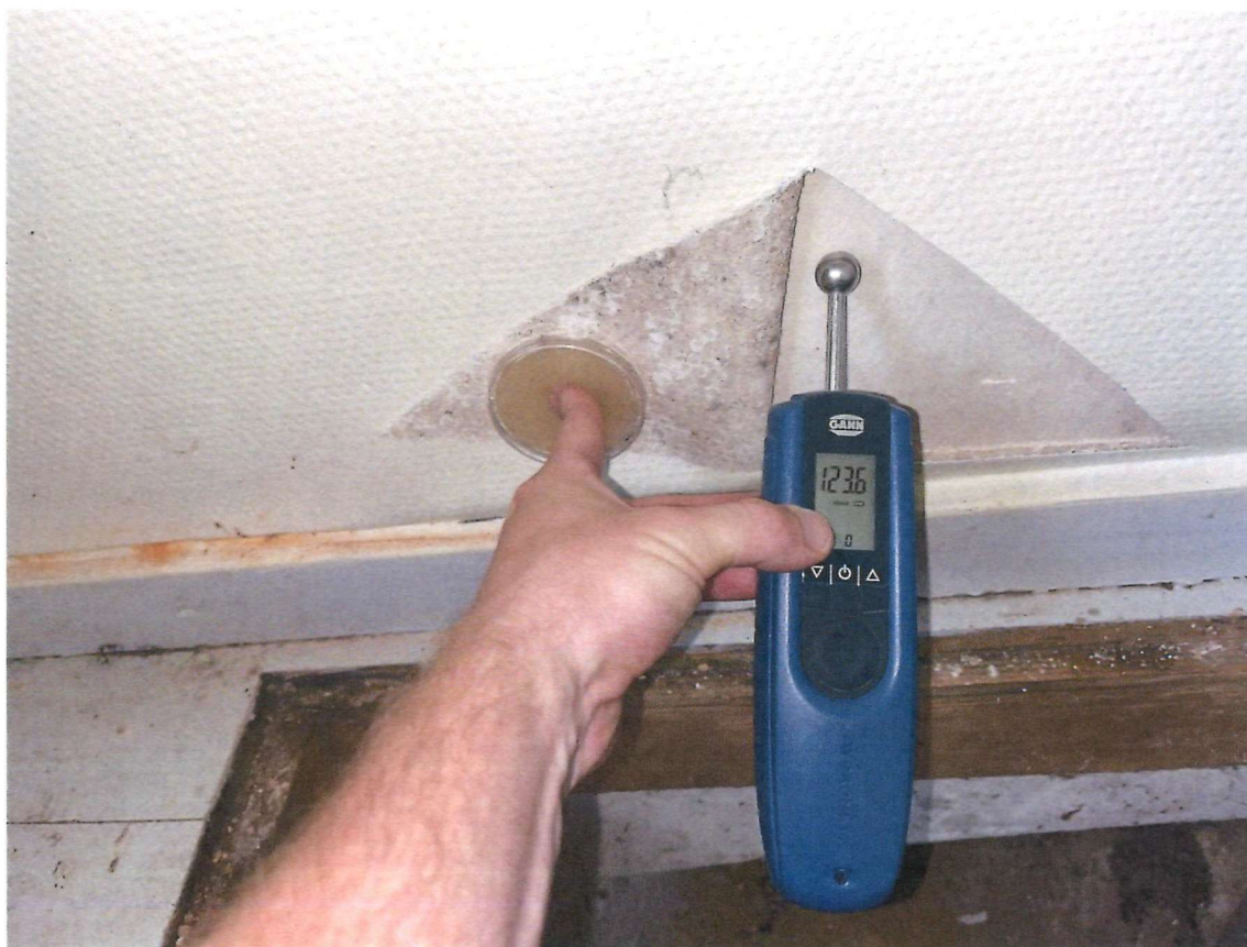
Kraftig opfugtning og skimmelp prøve nr. 4 i baggangen
