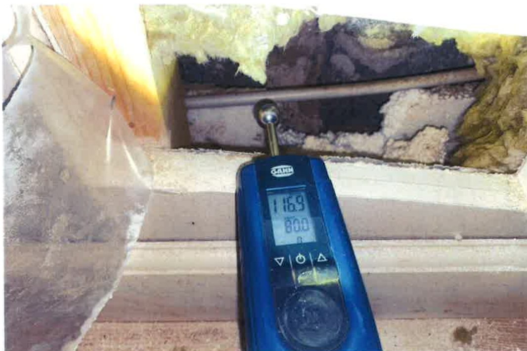
Fundamentet måles moderat opfugtet
