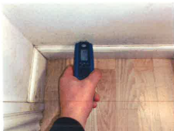
Forsatsvæggene i soveværelset måles moderat til kraftigt opfugtede
