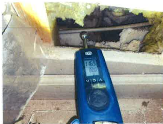
Ydervæggen måles opfugtet i stuen
